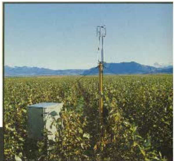
7. mynd: Tackjabúnaður sem notaður var í EUROFLUX-verkefnið sem gerði kleift að mæla með beinum hætti kolefnisflöndingu með skógrækt eða landgræðsu. Mynd: BDS. júlí 1996. [6, 7, 23, 24.]
