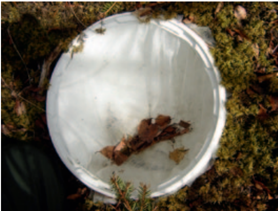
5. mynd: Fötur voru grafnar niður meðfram bökkum lækjanna til að safna þeirri feyru sem berst í lækina. Barmar fötunnar báru við jörðu og föturnar voru grafnar niður sitt hvoru megin lækjar.
