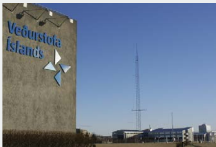
Vindmælar í mælareit við Veðurstofu Íslands. Staðalhæð vindmælinga er 10 metrar yfir jörðu, en mælir í toppi mastursins til hægri er í 30 metra hæð. Mynd: Sigvaldi Árnason.
