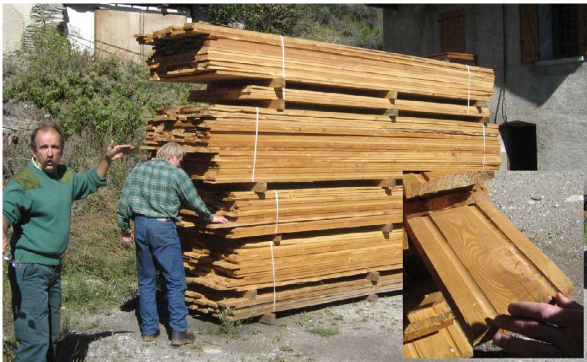
Michel Sappia skógarvörður í Cerviérs þjóðgarðinum lagði mikla áherslu á verðmæti viðarafurða úr evrópulerki. Hér er vænn stafl af þakborðum sem talin eru munu endast örugglega í a.m.k. 50 ár án nokkurrar meðhöndlunar. Á innfelldu myndinni má sjá hvernig borðin eru fræst til að regnvatn eigi greiða leið af þakinu. Mynd: SKP.
