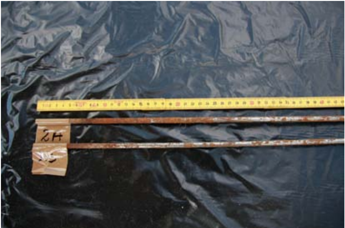
11. mynd. Tveir ryðteinar merktir 2A og 2B úr móajarðvegi í Hvammi, Landsveit. Svartur plastpoki sem hér er hafður sem bakgrunnur er of glansandi og erfitt að hemja utandyra. Betra er að nota spjald sem málað er með mattri málningu t.d. svartri. Merki er límt á þann enda teinanna sem stóð upp úr jörðu og tommustokkur lagður samsíða teinum, nákvæmlega við enda teinanna svo hægt er að meta ryð á mismunandi dýpi. Móinn var mjög þurr og stálið er gljáandi milli ryðskellanna. Efri teinninn er alryðgaður niður á 16,5 sentímetra. Um fimm sentímetrar stóðu upp úr og því var teinninn alþakinn ryði niður á 11 sentímetra dýpi. Mynd: PHJ 2015
