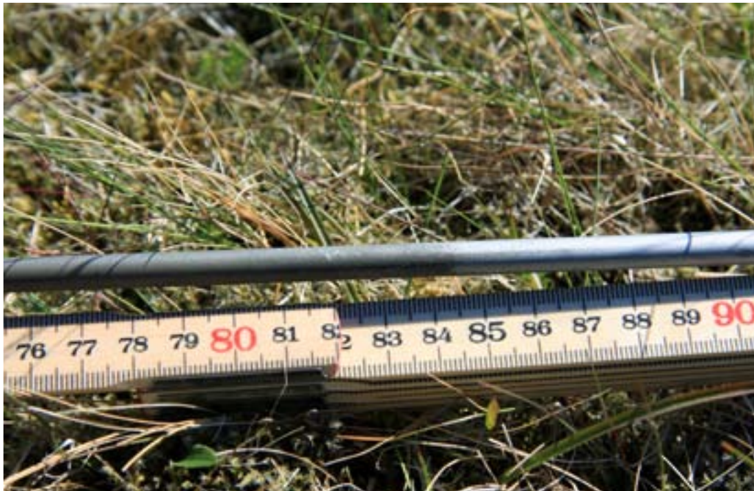
10. mynd. Við 85 sentímetra eru hér mörk svartrar skánar (dökk grátt vinstra megin) og matts grás stáls (hægra megin). Þarna eru talin mörkin milli jarðvegssúrefnis í snefilmagni og algers súrefnisleysis, þ.e. mörk oxandi og afoxandi umhverfis. Mynd: PHJ júní 2012
