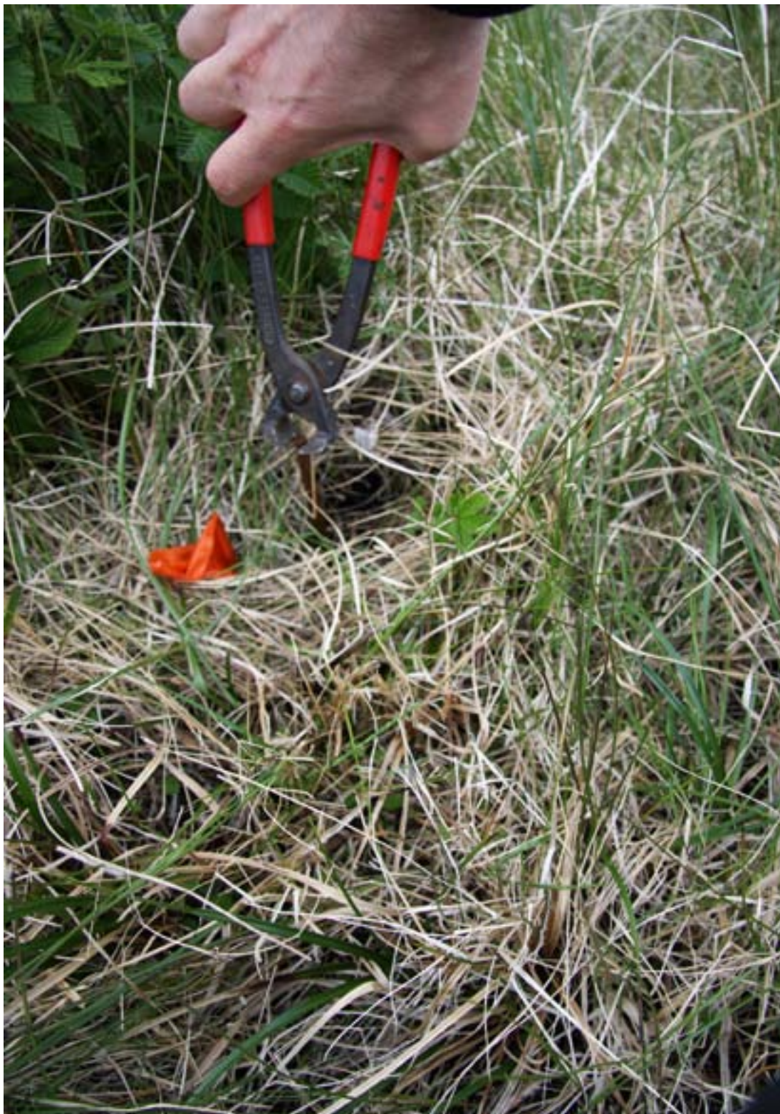
7. mynd. Gripið með naglbít í ryðtein. Mynd PHJ
