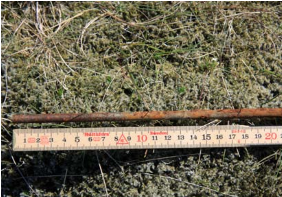
8. mynd. Yfirborð jarðvegsins var við 8,7 sentímetra frá enda ryðteinsins. Endinn sem upp úr stóð er með brúnu ryði og að mestu án ryðhrúðurs. Nánast óryðgað stál er 7,5 – 8,5 sentímetra frá endanum. Þessi hluti var í simulaginu en þar er oft lítil ryðgun. Frá jarðvegssyfirborði og eins langt og myndin nær (21,2 sentímetrar) er teinninn alryðgaður. Bakgrunnurinn er grámosi. Mynd: PHJ júní 2012
