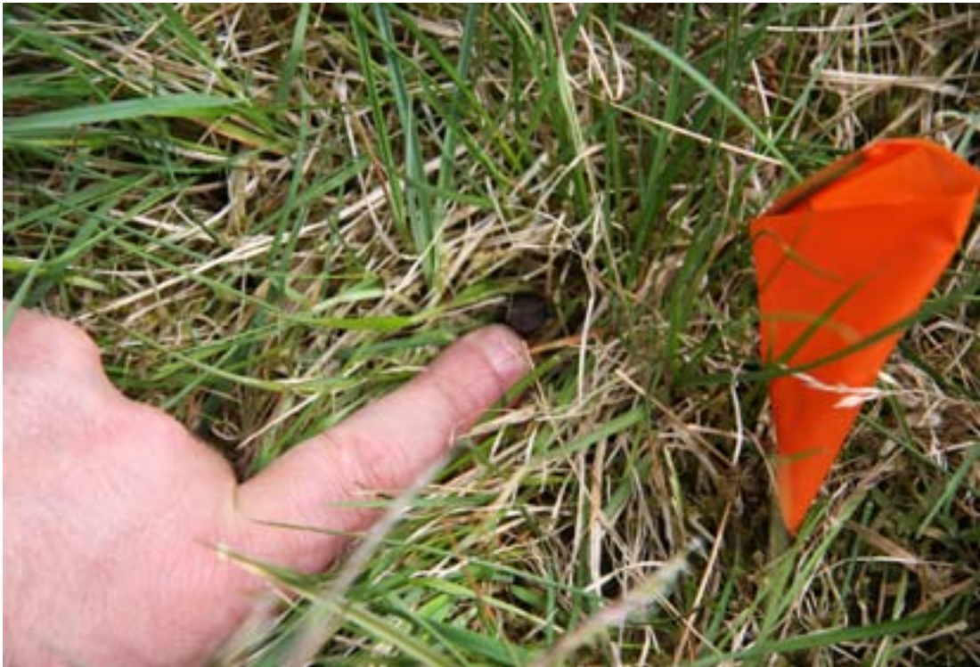
6. mynd. Fingurinn bendir á ryðtein sem hross tróð niður. Það er mjög mikilvægt að taka GPS-hnit af öllum ryðteinum og setja merki við þá. Skepnur, sérstaklega hross, rífa stundum upp merkin og troða á ryðteinum. Þá getur verið nauðsynlegt að hafa málmeitartæki til að finna þá aftur. Mynd: PHJ júlí 2012
