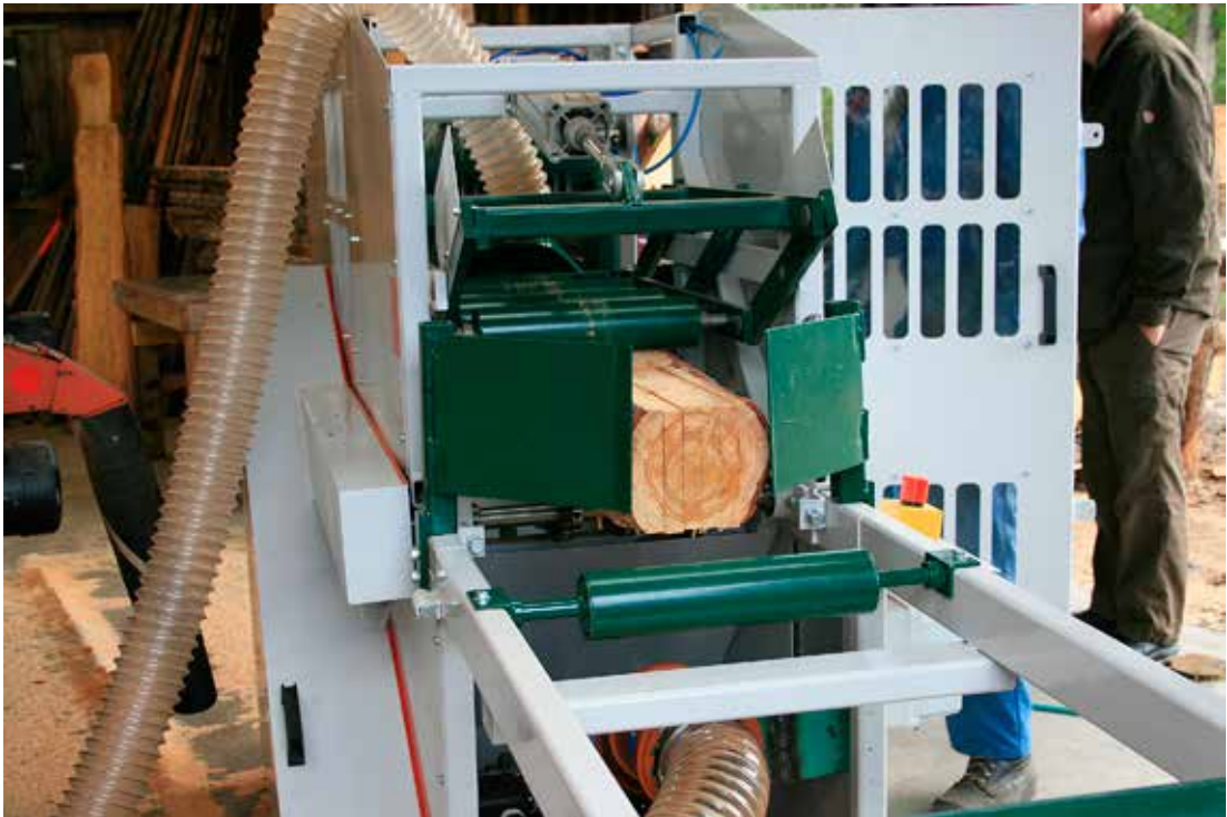
6. mynd. Lerkiborð á leið út úr nýrri rammasög á Hallormsstað. Aðeins lítill hluti grisjunarviðar hæfir í slíka framleiðslu og er árleg sala fáir tugir rúmmetra. Mynd: ÞE
