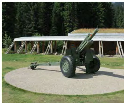
Sprengjuvarpa fyrir utan Rogers Pass upplýsingamiðstöðina. Á veturna eru slík tæki notuð, af kanadíska stórskotaliðinu (Royal Canadian Artillery) til að skjóta niður snjóhengjur (þ.e. koma af stað „stýrðum“ snjóflóðum) til að draga úr hættu á óvæntum snjóflóðum. Mynd: RF
