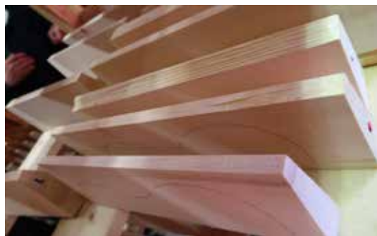
Viður ætlaður til hljóðfæragerðar. Búið er að sér velja hann eftir hljómgæðum og marka fyrirhugaðar útlínur hljóðfæra á bluta viðarins. Mynd: RF
