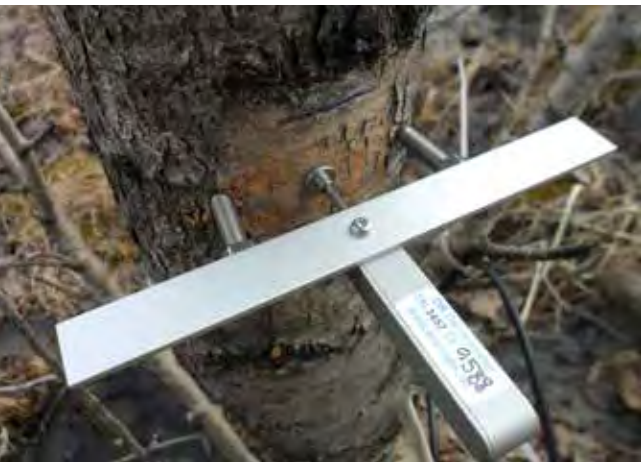
1. mynd. Þvermálmælir á ösp í Sandlækjarmýri, mælirinn kemur frá Ecomatik í Þýskalandi og kallast á ensku „point dendrometer“. Neminn er fyrir miðju og hvílir á berki trésins.
