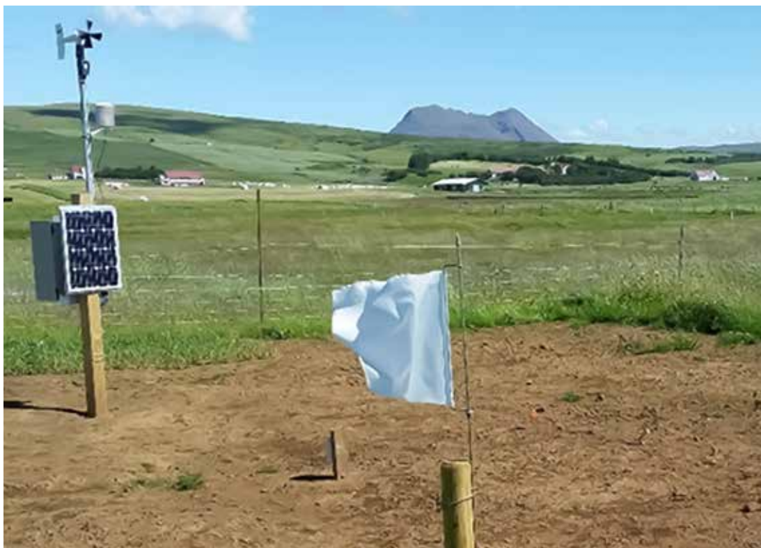
2. mynd. Slitflögg (e: Tatterflags) eru staðlaðir taufánar sem notaðir eru til að bera saman vindálag milli staða.
